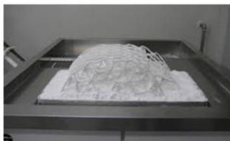
C'est le procédé de fabrication additive le plus utilisé dans l'industrie. Il repose sur la fusion d'un matériau sous forme de poudre.
